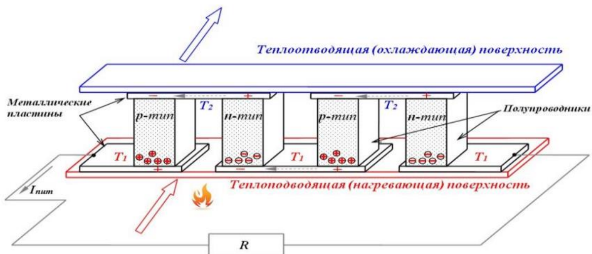
4.1-сурет – Термоэлектрлік жартылай өткізгіш генератордың жұмыс принципінің жеңілдетілген схемасы
